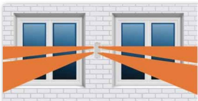
I rivelatori HE-210 a basso assorbimento per sistemi senza fili sono stati progettati per fornire una protezione perimetrale esterna, creando una barriera orizzontale a fasci multipli, che rileva la presenza di un intruso prima che faccia irruzione negli ambienti, mantenendo la libera circolazione negli ambienti interni senza generare falsi allarmi.
