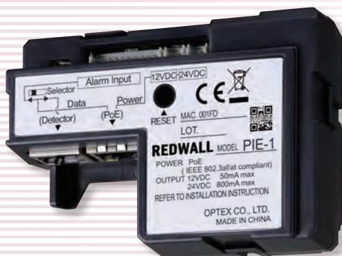
PIE-1 è un encoder che converte il segnale di uscite relè in un codice ASCII (Codice Eventi Redwall) per i rivelatori Redwall e Fiber SenSys. I rivelatori possono essere collegati a piattaforme VMS (Video Management Software) di gestione video attraverso l'encoder PIE-1 per comandare telecamere IP.
