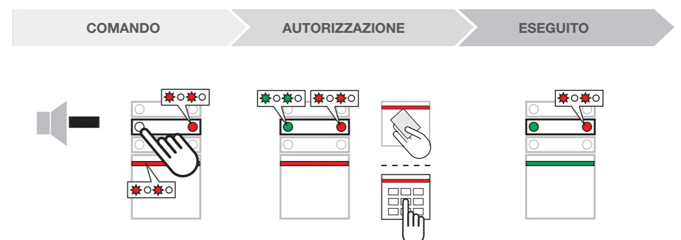
Può capitare che ci si dimentichi di spegnere il sistema e che questo inneschi un allarme. La luce rossa del LED del tastierino lampeggia insieme al LED della sezione corrispondente. È possibile interrompere l'allarme spegnendo il sistema. Il LED lampeggiante sul segmento indica la memoria allarme.
