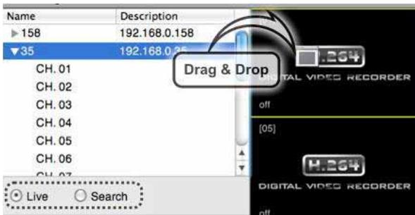
Il pannello mostra l'elenco dei videoregistratori digitali registrati. Per connettersi, selezionare la modalità [Live] (in tempo reale) o [Search] (ricerca) nel pannello della modalità di connessione e trascinare e rilasciare nello schermo di visualizzazione.
