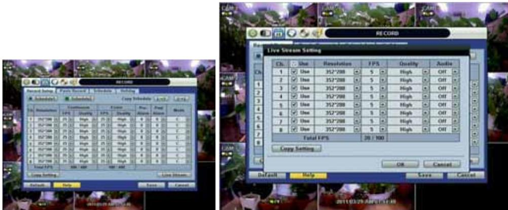
Il menu 'Live Stream' consente all'utente di ottimizzare i dati trasmessi in rete configurando risoluzione, FPS e qualità indipendentemente dalle impostazioni utilizzate in registrazione.
