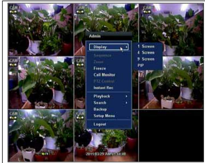
Selezionando [Sequenza] l'icona **SEQ** è visualizzata nell'angolo in basso a destra dello schermo e il display viene cambiato in sequenza.
