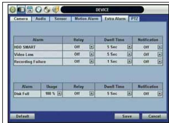
L'utente può impostare la percentuale di utilizzo dell'HDD. Per esempio, quando 'Hdd Usato' è impostato a 50%, il videoregistratore avvisa l'utente con un pop-up della telecamera oppure emette un segnale di beep quando l'hard disk è pieno al 50%.
