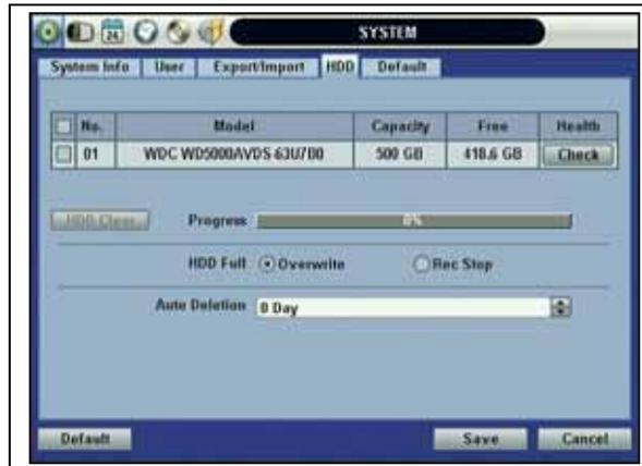
Health: Cliccare il tasto [Check] sotto Health per visualizzare la finestra [Health Check]. [Health Check] visualizza il modello, la dimensione, la temperatura e la durata di vita del HDD.
