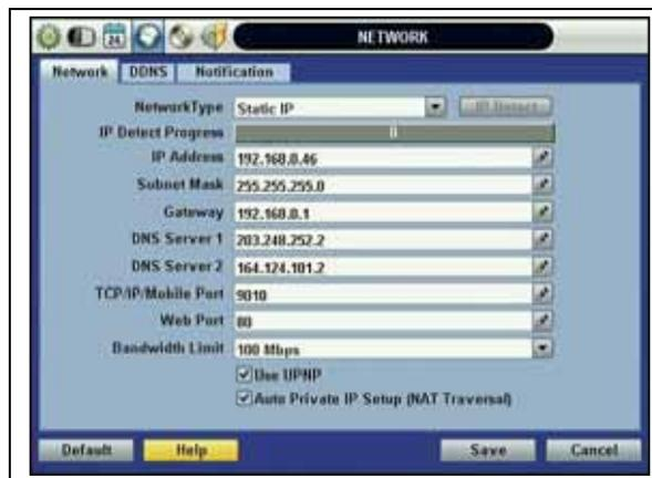
**DNS Server:** Sono possibili due impostazioni del DNS (DNS preferito e DNS alternativo). Digitare l'indirizzo IP del Domain Name Server DNS Server per usare internet. (Fornita dal provider Internet)
