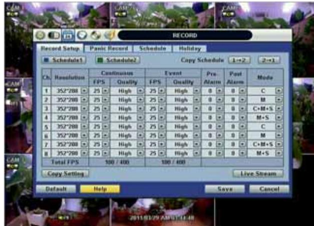
Gli utenti possono configurare le impostazioni di registrazione quali risoluzione, FPS, qualità, pre/post-allarme e tipo di registrazione per registrazione normale (continua) o registrazione su evento (allarme o movimento) in ciascuna programmazione.
